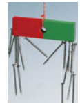
B3 An den Enden des Magneten befinden sich die Bereiche mit der grössten Kraft.
